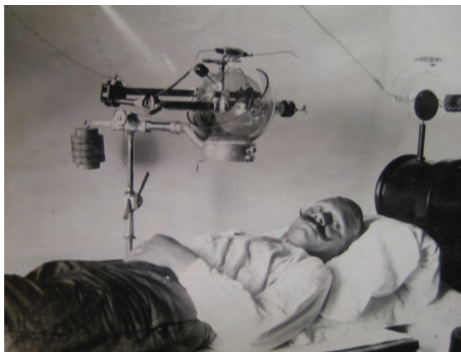
Installation radiologique dans un hôpital toulonnais. Tube à anode fixe semi protégé ; fils aériens (22) (DR).
